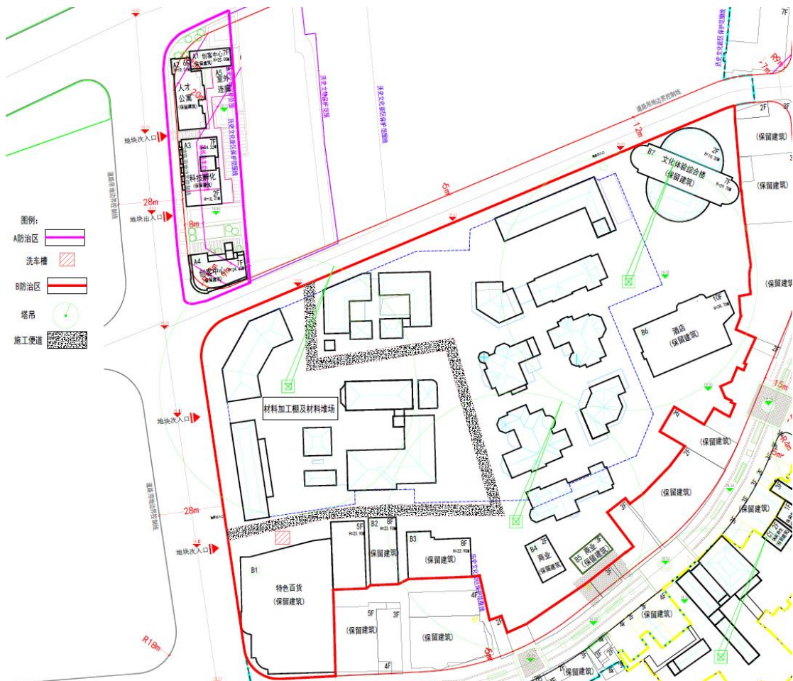
图 1-4 施工过程中施工场地布置图
