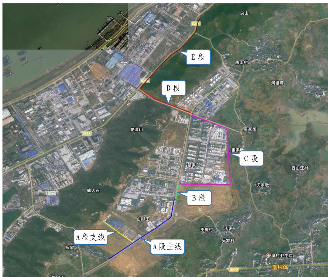
图 2.2 综合管廊工程各段划分图
