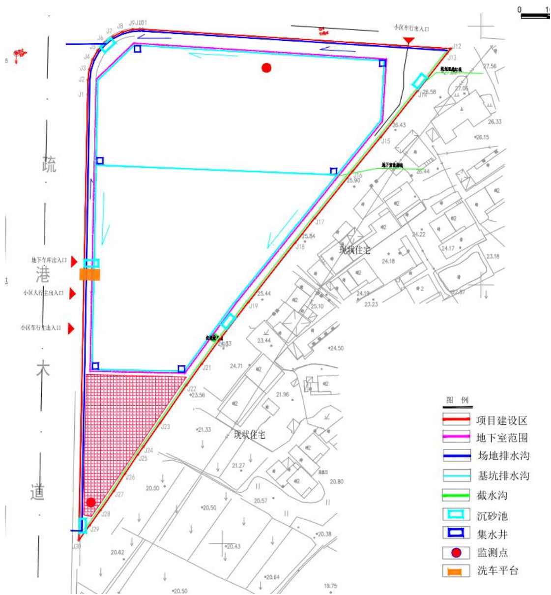
施工过程中施工场地布置图
