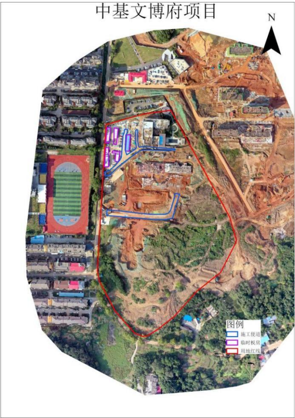
施工过程中施工场地布置图
