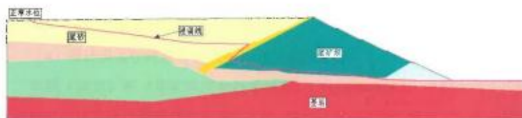
图5-1 一期坝体正常水位渗流流网图
