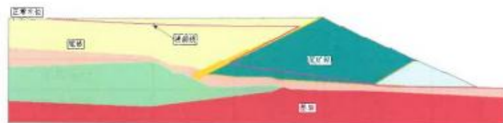
图5-3 二期坝体正常水位渗流流网图
